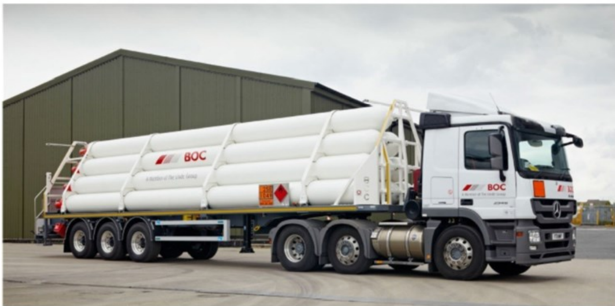
Een tube-trailer met 9 stalen drukcilinders ( 200 bar ) (M-Tech, 2020)
